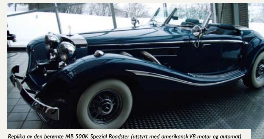
Replika av den berømte MB 500K Spezial Roadster (utstyrt med amerikansk V8-motor og automat)
